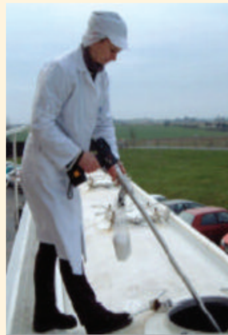
Exonder: prelevatore portatile per polveri
